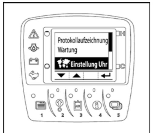
Durch Drücken der Taste 4 kann zwischen den Zeiteinheiten Jahr, Monat, Tag, Stunden und Minuten gewechselt werden.
