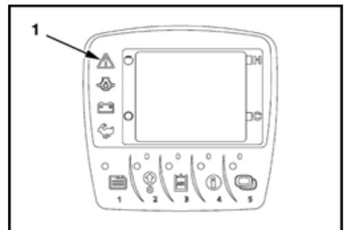
Ist während des Betriebes nicht genügend Motoröldruck vorhanden, muss der Motor sofort abgestellt werden. Die Kontrollleuchte Motoröldruck (2) leuchtet, die Warnleuchte (1) blinkt rot und im Display erscheint die Meldung wie im Bild rechts dargestellt.
