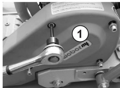
Keilriemen (1) auf Risse, ausgebrochene Flanken sowie Verschleiss prüfen.
