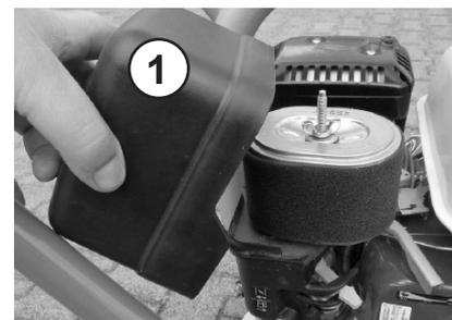
Luftfiltereinsatz (1) aus dem Luftfiltergehäuse entnehmen. Luftfiltereinsatz gem. Vorschrift des Motorenherstellers reinigen, bei Beschädigung oder extremer Verschmutzung austauschen.
