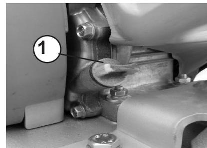
Korrekter Ölstand zwischen min. und max. Markierung.
