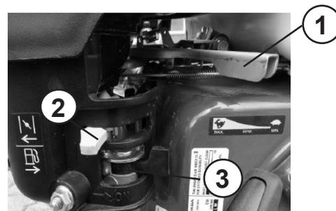
Handgriff (1) des Reversierstarters (2) langsam anziehen, bis Widerstand spürbar wird.
