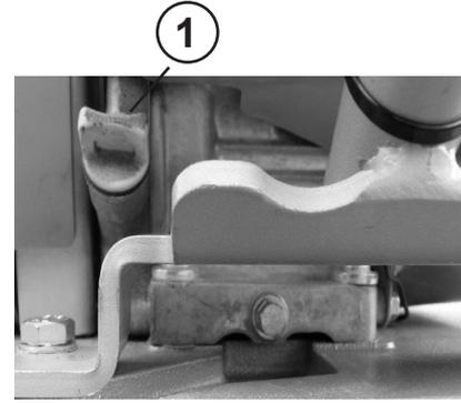
Ölablassschraube (2) entfernen und Öl ablassen.
