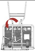
6. Den Spannhebel gegen den Uhrzeigersinn drehen um das Greifgut zu lösen.
