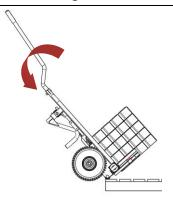
4. Die VTK-V zum Körper hin kippen und mit der Laufrolle zum Rand der Palette ziehen, so dass die Räder der VTK-V über die Palette hinausschauen.
