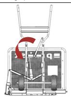
6. Am Bestimmungsort die VTK-V vorsichtig in die Senkrechte Position bringen und den Spannhebel gegen den Uhrzeigersinn drehen um das Greifgut zu lösen.
