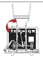
3. Spannhebel bis Anschlag im Uhrzeigersinn umlegen, so dass das Greifgut eingespannt wird.
