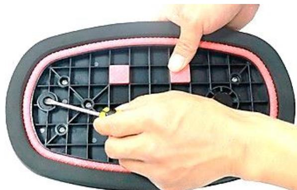
Neuen Filter (oder gereinigter Filter) einsetzen und Kunststoffstopfen (Ring) wieder hineindrücken, um den Filter zu sichern.
