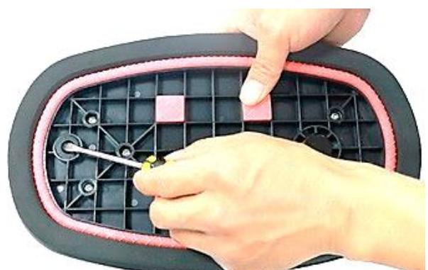
Aseta uusi suodatin (tai puhdistettu suodatin) ja työnnä muovitulppa (rengas) takaisin paikalleen suodattimen kiinnittämiseksi.
