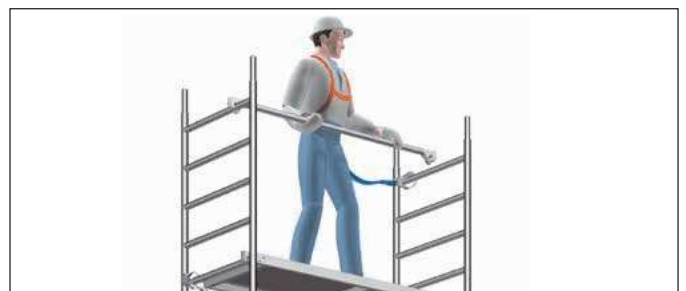
Bild 3: Sichere Montage des Geländers mit PSA
