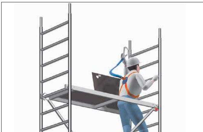
Bild 1: Anschlag der PSA während des Aufstiegs in die ungesicherte Lage
