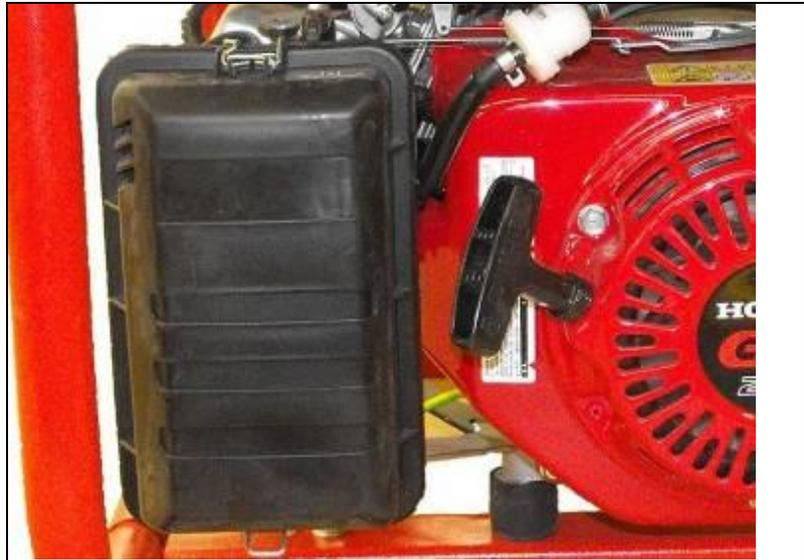
Abb. 4.7: Luftfilter entfernen
