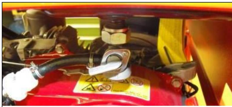
Abb. 4.5: Kraftstoffhahn schließen
