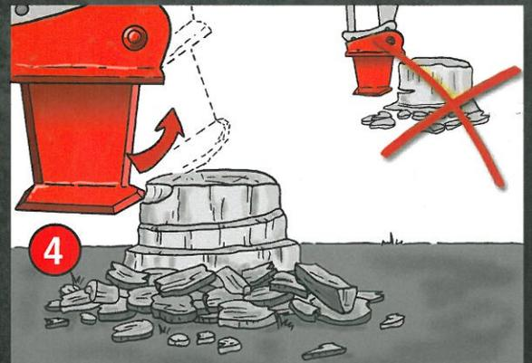
Der Wurzelstock kann kontinuierlich von einer Seite aus gerodet werden, von oben nach unten. **Nicht zu tief ansetzen!**
