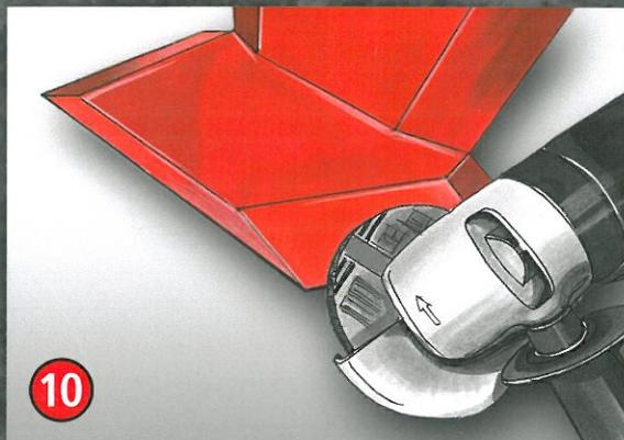
Die **Wurzelratte** kann leicht mit einem Winkelschleifer im vorgegebenen Winkel mit der Schruppscheibe nachgeschärft werden.
