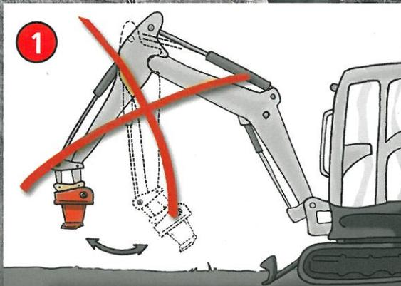
Nicht zu sehr den Löffelstiel einsetzen, um den Bagger nicht an den Wurzelstock heranzuziehen.
