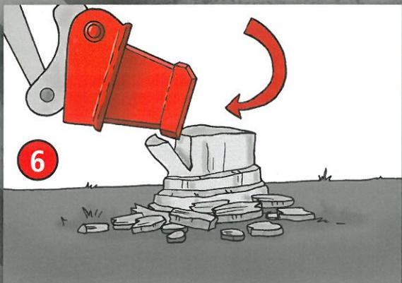
Um bei fortgeschrittener Rodung ein Abrutschen der **Wurzelratte** zu vermeiden, setzt man diese von oben mit der hinteren Schneide auf den Wurzelstock auf, um mit einer Kipp-Bewegung nach hinten die Fasern wegzubrechen.
