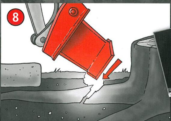
Wurzeln, die sich **UNTER** Belägen, Asphalt, etc. befinden, können punktgenau mit einer Bewegung nach unten mit den 4 Schneiden abgetrennt werden.
