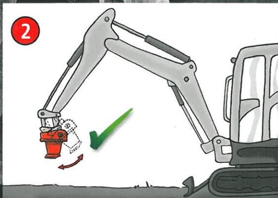
Nutzen Sie vorwiegend die Bewegung der Löffelhydraulik, hier hat der Bagger die größte Losbrechkraft.
