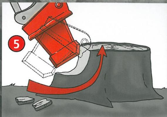
Durch die Kipp-Bewegung können auch größere Holzstücke des Baumstumpfes sowie des Wurzelanlaufes entlang der Faser aufgebrochen werden.
