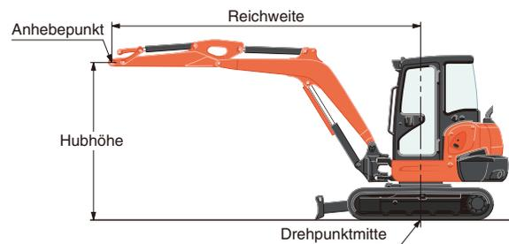
\* Die technischen Daten über den Arbeitsbereich der Maschine wurden mit dem Kubota Standard - Tiefloffel, ohne Schnellwechseinrichtung ermittelt.
