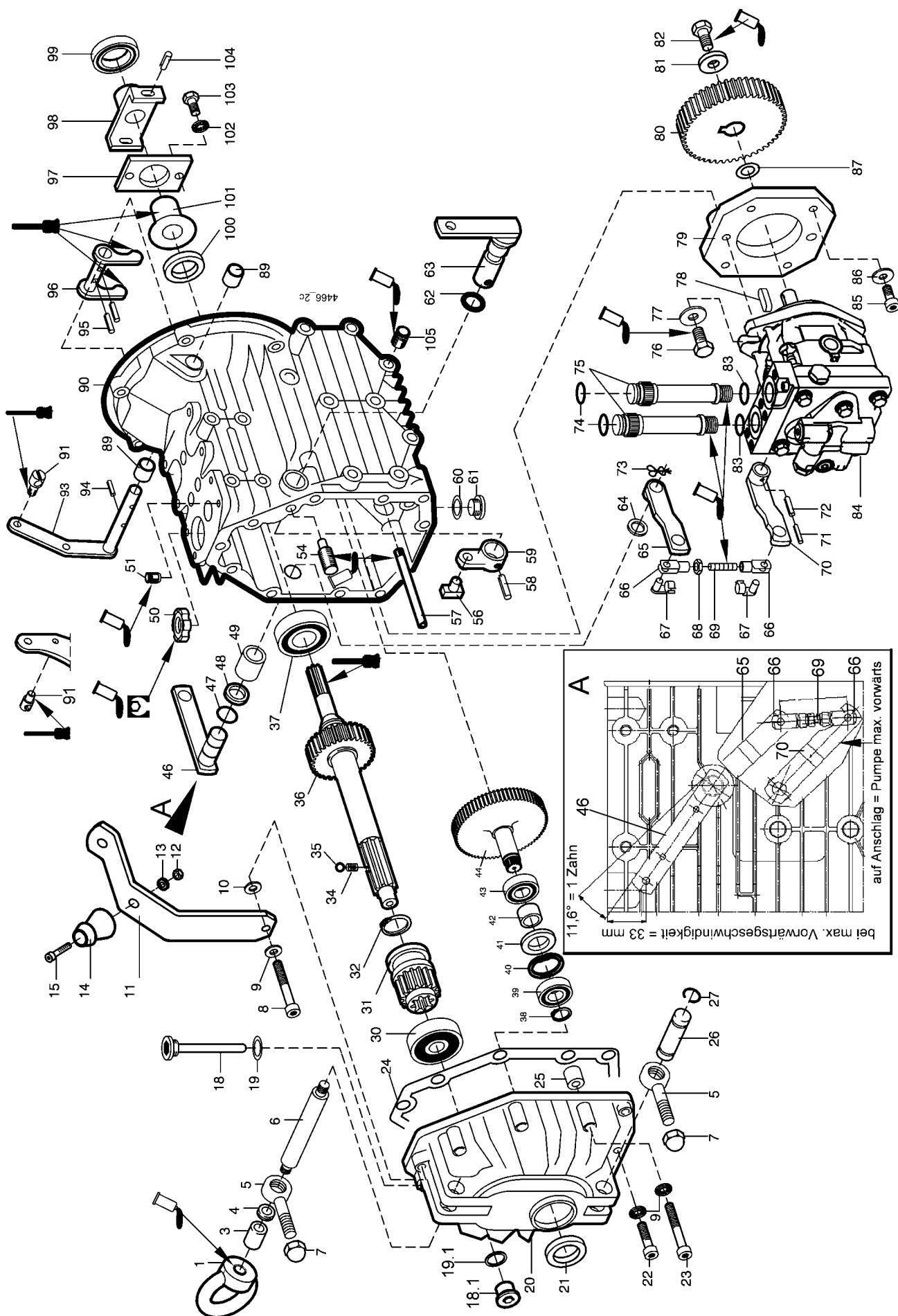
**Tafel 252102 Getriebe mit Hydropumpe APC-10LR**
